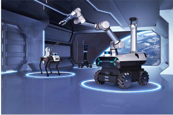
●联想晨星工业机器人是一款典型的以视觉智能技术为基础，融合多种能力模块的第三代智能机器人。它融合“手脚眼脑”，以一体化设计和强大的能力组合赋能多种复杂工业应用场景。“手”即灵活的多关节、多自由度机械臂和执行末端，“脚”是机器人的可移动性，“眼”就是机器人的各种相机和传感器，“脑”更是机器人的智能水平。
