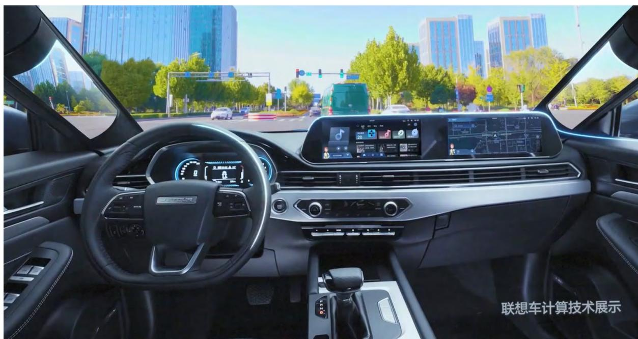
2022 年 11 月，联想首次展示全新概念智能座舱系统，系统包括一机多屏、智能座舱域控制器、曲面透明 A 柱系统（包含柔性曲面屏和对应的景物融合算法）、驾驶员健康监测系统、多设备无线充电等智能产品，以及柔性曲面中控屏、双联屏等更贴合座舱的车载屏幕和对应的用户界面。
